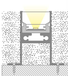
On fixe la bande au guide en aluminium pour une introduction précise et rapide.
